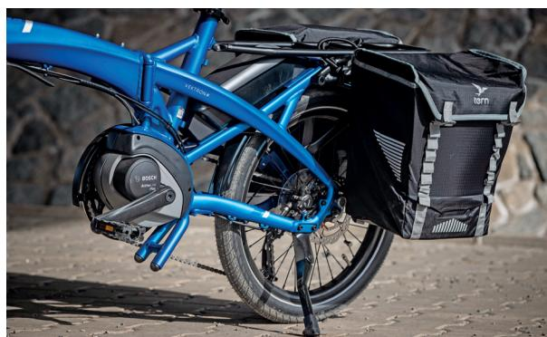
Vektron má pevnou oporu ve výklopném stojanu a pod motor ještě trčí dva masívní modré „růžky“, které kryjí motor, když chcete kolo postavit ve složeném stavu.
