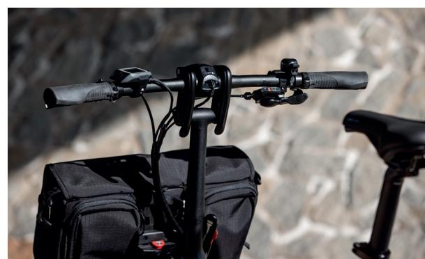
Kokpit s řazením, displejem, světlem, zvonkem. Jeho sklon je jištěn dvěma obrovskými pákami.
